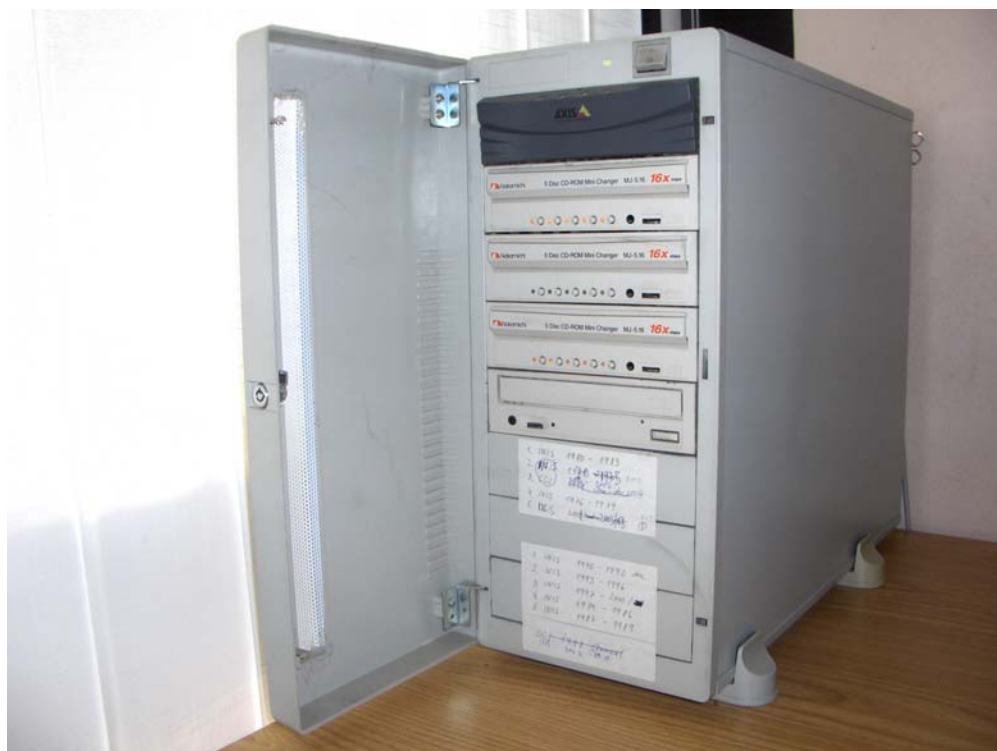
Obr. 10 a 11. Počítačová zostava Detašovaného pracoviska SNC INIS v Chemickej študovni Prírodovedeckej fakulty Univerzity Komenského: hore – server (vpravo), skener a systém AXIS (vľavo), dole – otvorený systém AXIS, umožňuje súčasné umiestnenie až 16 CD-ROM.
