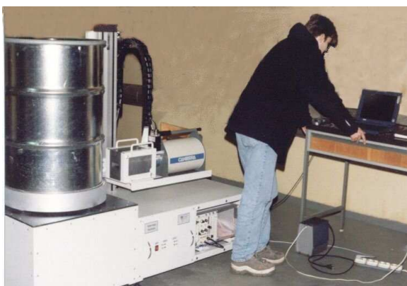
Obr. 1: Fotografie segmentového gamascanneru s měřeným objektem - 200 l sudem
