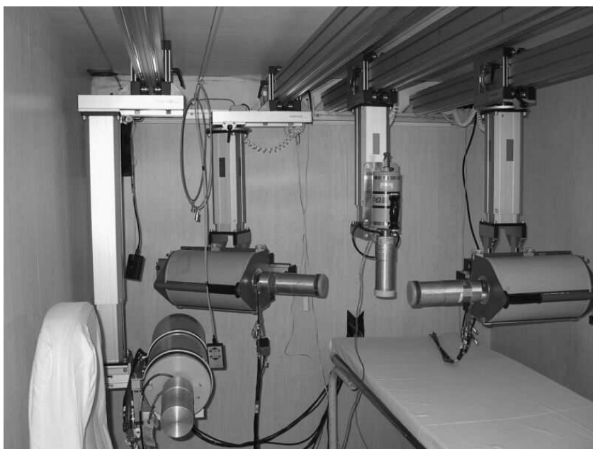
Obr.1 Uspořádání detektorů v první komoře CTP po rekonstrukci.
