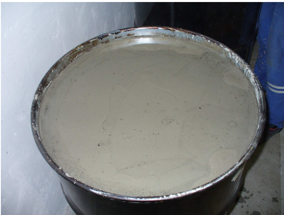
Obrázek 2: 200 L sud vyplněný betonovou směsí.
