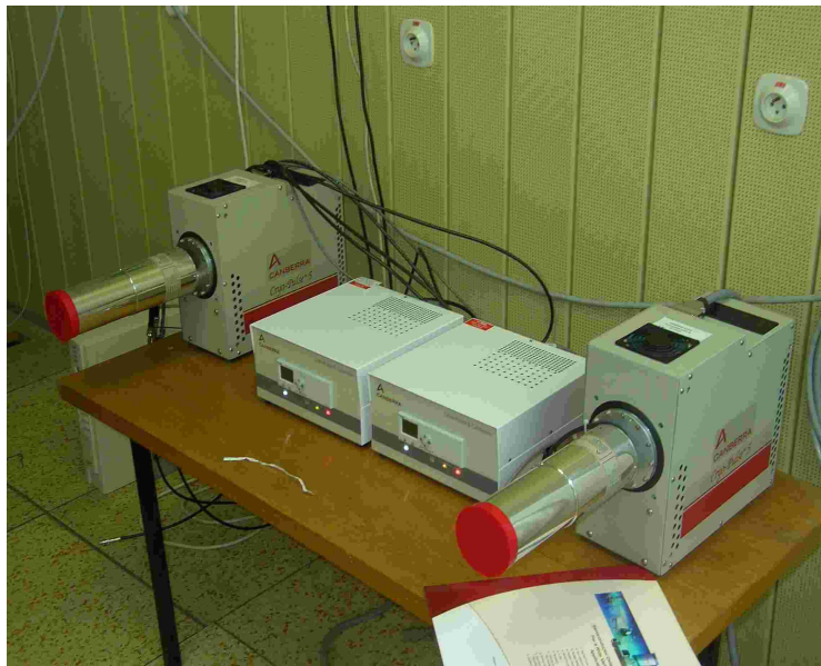
Obr. 1 Schéma tieniaceho domu KPV 01 s detektorom a foto spektrometrickej zostavy 2x Lynx + 2x HPGe Cryopulse 5 pre GSPM systém JE Pakš pri testovaní v laboratóriu VUJE
