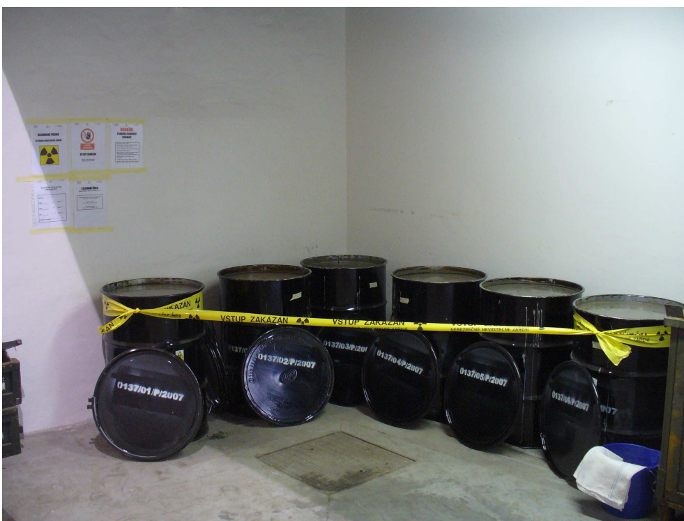
Obrázek 3: Sudy se zrající betonovou směsí ve sledovaném pásmu Přelouč.
